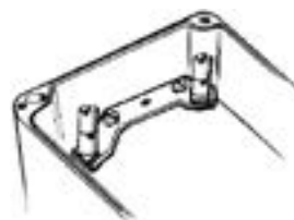
Заземление с клеммами
